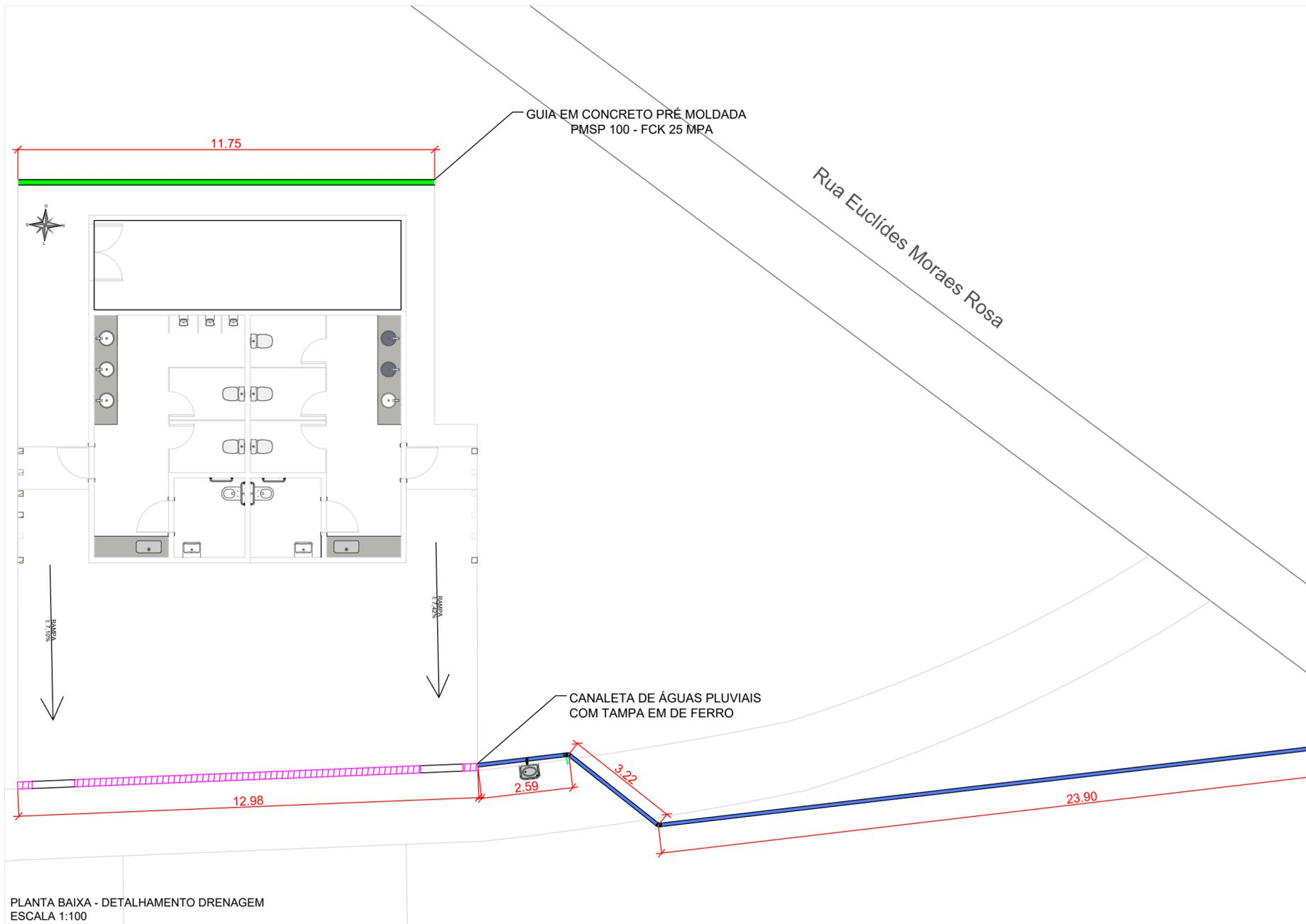
PLANTA BAIXA - DETALHAMENTO DRENAGEM
